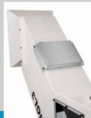
O poderoso ímã de calha captura o metal e protege as lâminas de corte de aço temperado.
